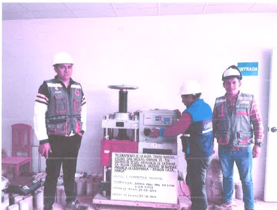
FOTOGRAFIA N° 01 : SE MUESTRA LA DETERMINACIÓN DE LA CALIDAD DEL CONCRETO MEDIANTE EL ENSAYO DE RESISTENCIA A LA COMPRESIÓN.
