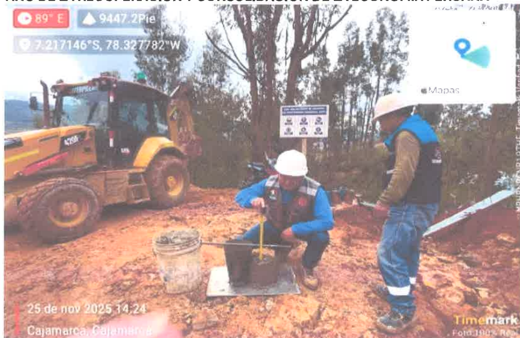
FOTOGRAFÍA N.º 07.- ENSAYO DE ASENTAMIENTO DE CONCRETO, ANTES DEL VACIADO.
