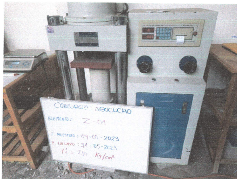
FOTOG 2.- La imagen muestra ensayo a compresión de espécimen de Zapatas (Z-01)
