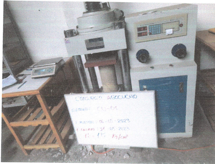
FOTOG 1.- La imagen muestra ensayo a compresión de espécimen de Cunetas (CU-01)
