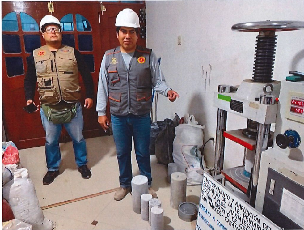
IMAGEN 25: ENSAYO DE COMPRESION ROTURA DE PROBETAS
