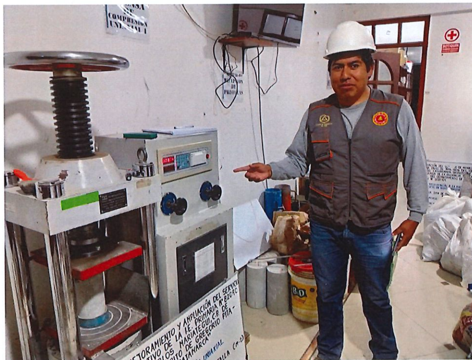
IMAGEN 26: ENSAYO DE COMPRESION ROTURA DE PROBETAS
